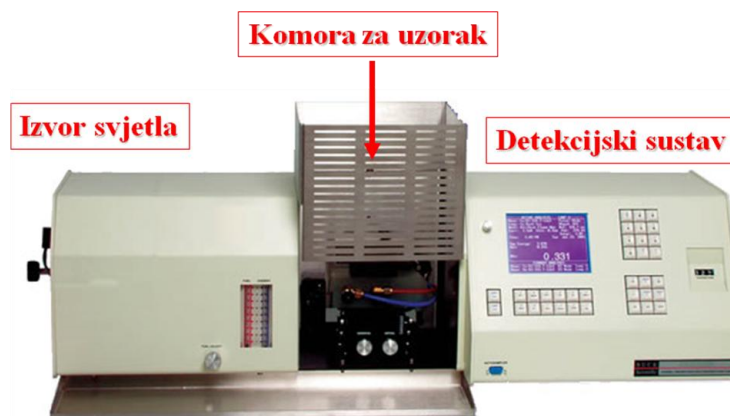
Slika 7.2. Atomski apsorpcijski spektrofotometar se sastoji od izvora svjetla, komore za uzorak i detekcijskog sustava.
