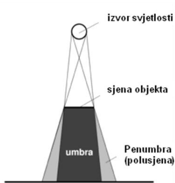
Slika 6.5. Lijevo: nastanak sjene i polusjene ovisno o položaju izvora svjetlosti (ili bilo kojeg EM zračenja). Desno: ovisnost veličine penumbre o veličini izvora zračenja i relativnim udaljenostima između izvora i objekta, i objekta i filma/detektora.
