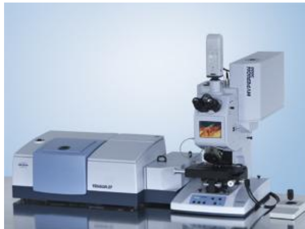
Slika 12.5. Tipičan uređaj za FTIR spektroskopiju, povezan s IR mikroskopom (na slici TENSOR 27 FT-IR spektrometar s HYPERION 3000 FT-IR mikroskopom, Bruker Optics) [11]
