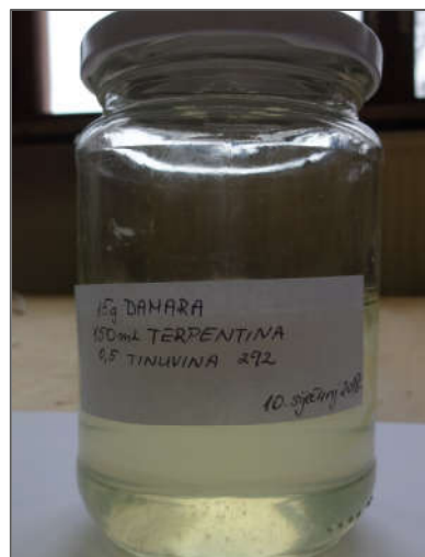
Slika 28 Na staklenku se bilježe točne količine sastojaka u laku i datum kada je otopina izrađena
