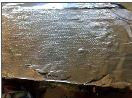
**Slika 34.** Metalna folija preko koje se postavlja silikonski kalup i uzima otisak strukture platna.
