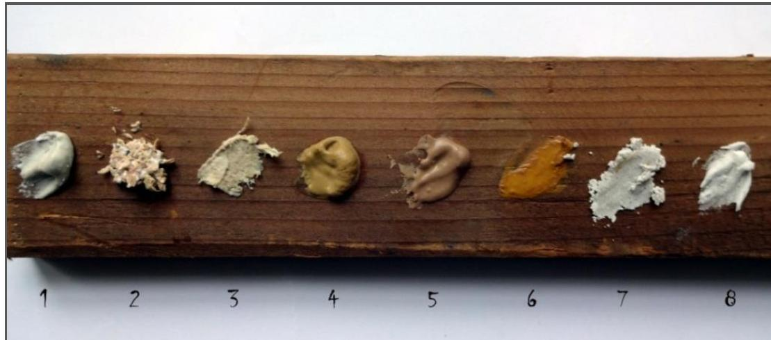
**Slika 18.** Različite vrste kitova, samostalno pripremljeni i komercijalni: 1) tutkalno-kredni; 2) Drvofix sa grubom mljevenom piljevinom; 3) Drvofix sa finom mljevenom piljevinom; 4) Clou Holz kit; 5) Akrilin; 6) Grillith;7) Beva Gesso kit; 8) Beva 371 sa šupljim staklenim kuglicama 55 µm. Kitovi, 1. dan –svježe naneseni, u tekućem stanju. Autorica fotografije: Tamara Ukrainiančik (2018.).
