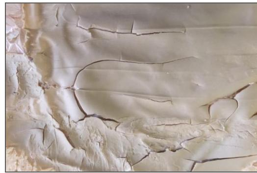
**Slika 63.** Izrada kita Beva 371. Ugrijana smjesa kita. Suhu kit koji se može rezati u željene formate.
