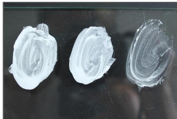
**Slika 22.** Različita punila, s lijeva na desno: Staklene pločice -15 µm, stakleno brašno -15 µm, i staklene kuglice -cca 55µm.Različite veličine čestica. Autorica fotografije: Lucija Močnik Ramovš (2017.).
