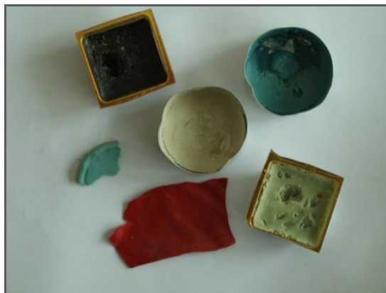
Slika 59. Izrada sintetičkog voštano-smolnog kita. Gotovi raznobojni kitovi. Autorica fotografije: Tamara Ukrainčik (2018.).
