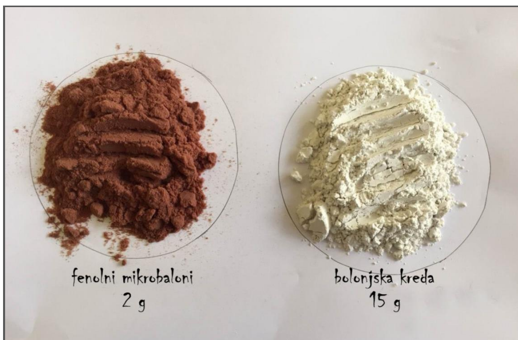
Slika 23. Zbog različitih veličina i težina čestica, 2 g fenolnih mikrobilona po volumenu izgleda kao 15 g bolonjske krede. Autorica fotografija: Tamara Ukrainčik (2018.).
